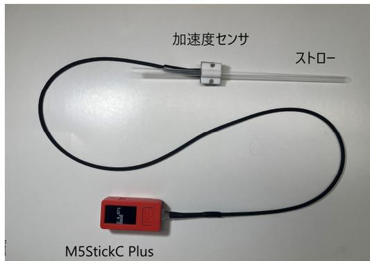
図3 加速度センサを取り付けたチューブと M5StickC Plus
