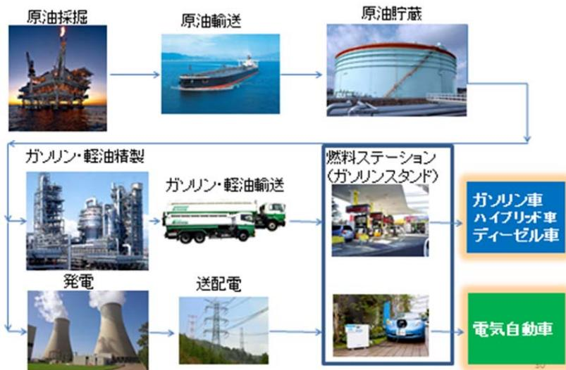
そのため、上図のようなエコカーを評価する上でエネルギーパスというのをを用います。車の性能(燃費効率)だけでなく車に必要なエネルギーを生産、輸送、貯蔵等にかかったそのエネルギーとそれに伴って排出されたCO2などをすべてをひっくり返して見るといふもの
