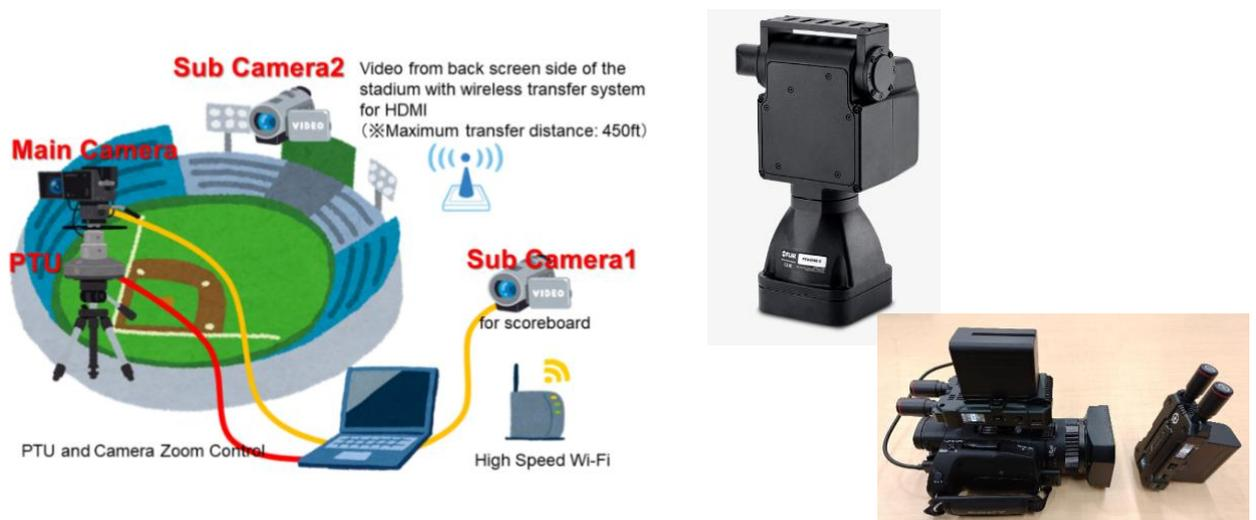
図 2：自動中継送信システムの全体図と装置の一部
